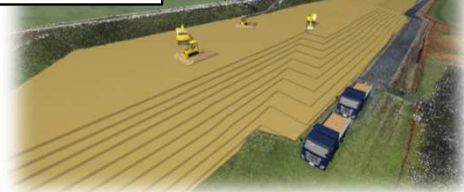
敷均し・転圧
