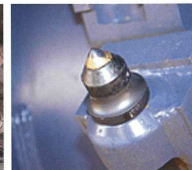
ビットは均一に摩耗する構造になっています (チルメッキ、コーティング機構)
