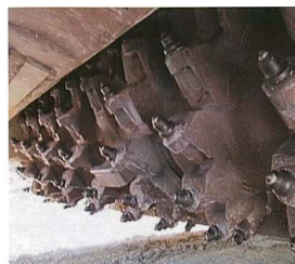
ドラム全景(ビットは容易に交換できます)
