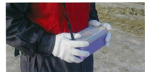
オペレーターの省人化、機械周りの安全性の確保が図れます 転倒時は、機械が停止します(デッドマン)
