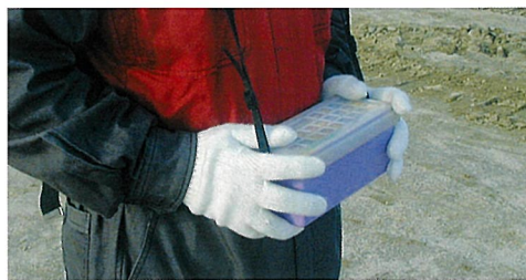
オペレーターの省人化、機械周りの安全性の確保が図れます 転倒時は、機械が停止します(デッドマン)
