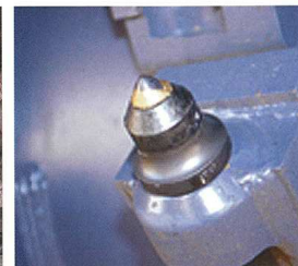
ビットは均一に摩耗する構造になっています (キルフィッシュ・ブローイング機構)
