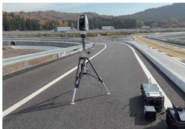
レーザートラッカーによる点群計測
