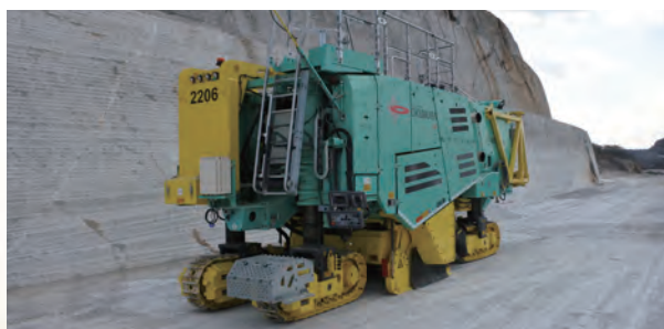
岩盤切削機(サーフィスマイナー)220SM
