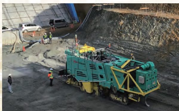
岩盤切削機（サーフィスマイナー）220SM 3D-MC (ICT施工)
