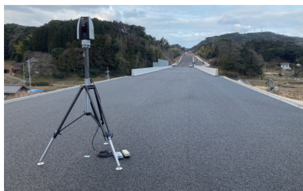
レーザートラッカーによる3次元計測状況
